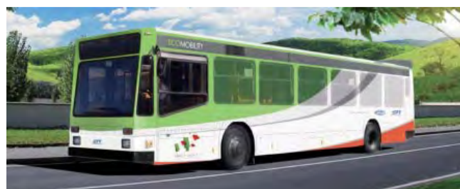
Hybus. La conversione in ibrido di un vecchio mezzo permette di risparmiare circa il 60% rispetto all'acquisto di un bus ibrido nuovo
